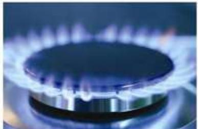
При сжигании газа в условиях дефицита кислорода (когда закрыты форточки и вентиляционные каналы) выделяется ядовитый угарный газ (СО). Признаком неполного сгорания газа является коптящее пламя горелок газовой плиты.
